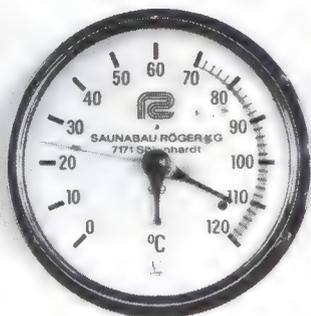
◀ Sauna-Kontakt-Thermometer mit rot gekennzeichnetem Badebereich von 70 bis 120 Grad Celsius. Meßbereich 0 bis 120° Celsius.
