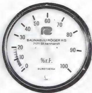
Hygrometer mit rot gekennzeichnetem Badebereich von 4 bis 20 %. Meßbereich 0 bis 100 % relative Luftfeuchte.
